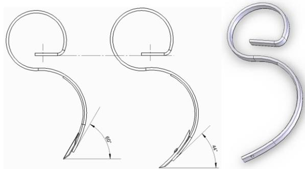
Fig. 2 Holders with knives at 60° și 44°. Elastic holder.
